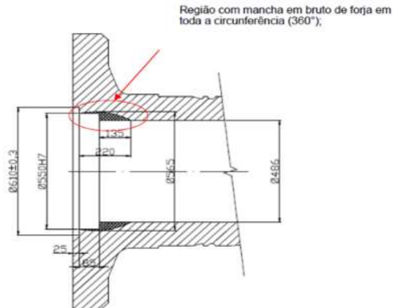
Figura 6: Detalhamento da região não conforme do eixo propulsor. Fonte: Autor.
