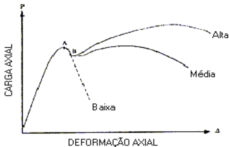
Figura 2.12 - Comportamento de pilares em CAR sujeito a cargas concêntricas com taxas diferentes de armadura transversal (ACI 441 1997)
