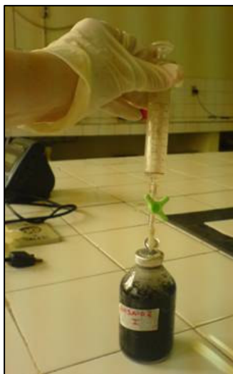
Figura 7.3: Coleta de gás por seringa de vidro graduada
