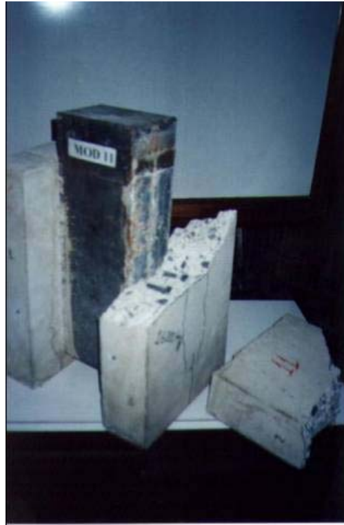
Foto 4.1- Ruptura no modelo: concreto sem armadura e conector rebite com roca interna.
