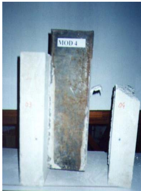
Foto 4.3- Deformação plástica do conector e posterior rompimento do concreto.
