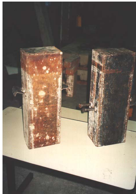
Foto 4.4 – Configuração dos conectores após ensaio.
