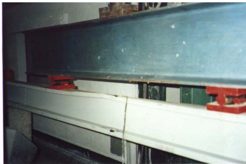
Foto 4.6 – Perfil I enrijecido – Flambagem lateral com torção (FLT)
