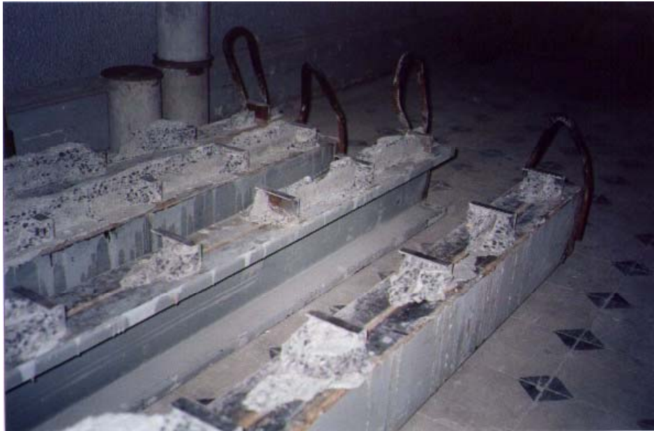
Foto 4.7- Conectores de cisalhamento após ensaio das vigas mistas
