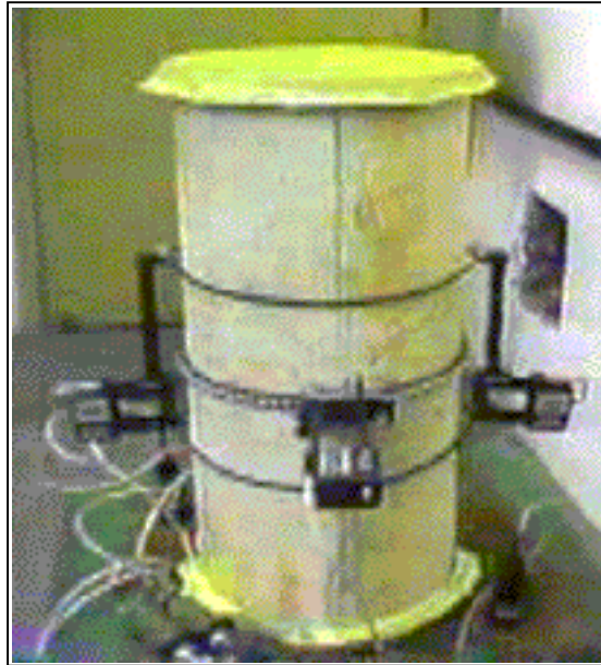
Figura 3.5 – Detalhe da colocação dos transdutores axiais e transversal
