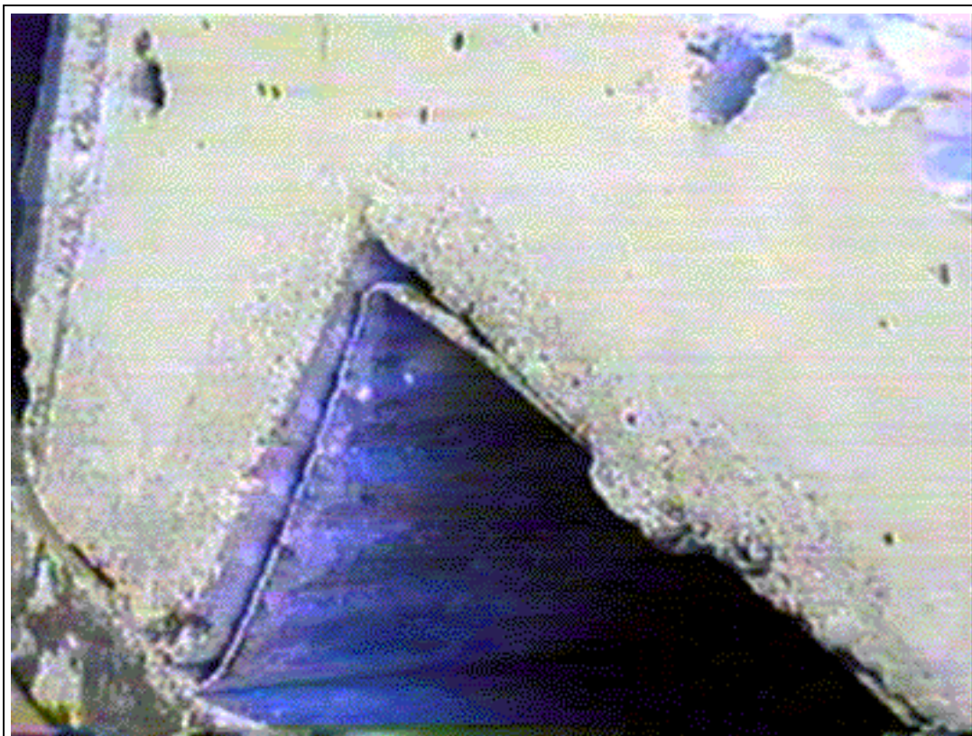
Figura D.9 – Detalhe do deslizamento relativo de extremidade ocorrido
