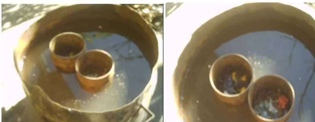
Figura 4.28 e 4.29 – Processos da Saturação da Amostra de Resíduos Sólidos Urbanos
