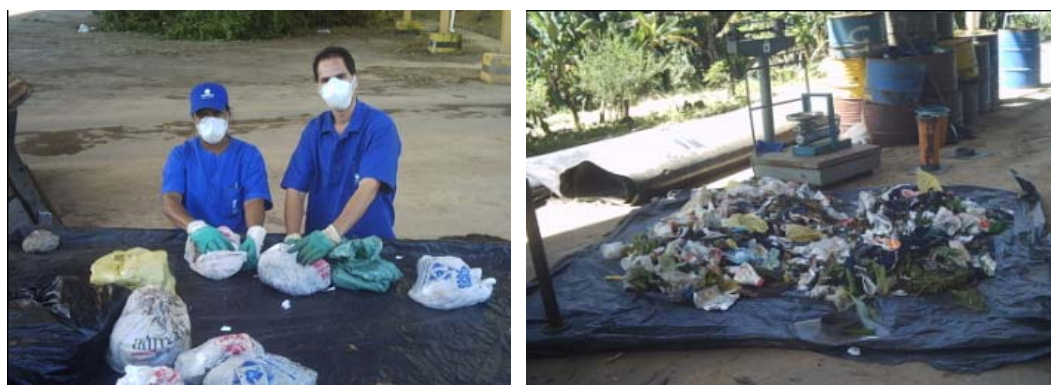
Figura 4.20 e 4.21 – Triagens da Amostra e Dispostos para a Composição Gravimétrica
