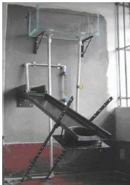
Figura 4.37 – Aparelho Inderbitzen usado nos ensaios : FRAGASSI (2001)
