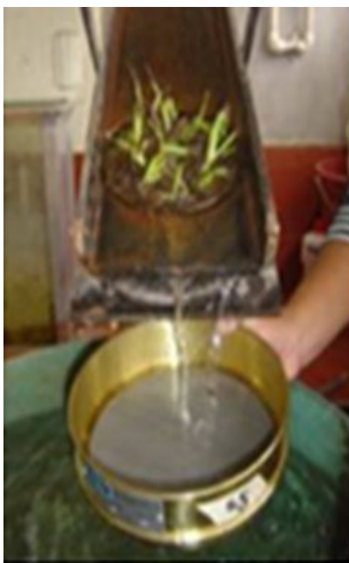
Figura 5.83 – Ensaio realizado com e sem cobertura vegetal W% 20 e Q = 2,3 l/min
