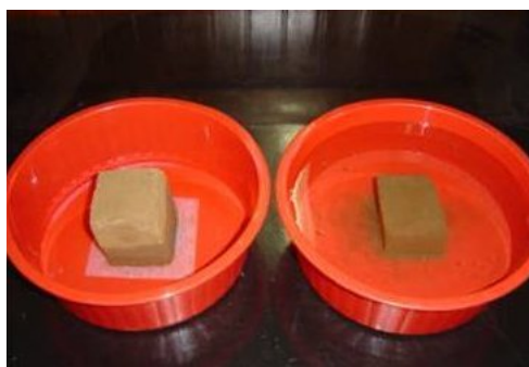
Figura 5.76 – Métodos de Imersão Parcial e Imersão total da amostra P2
