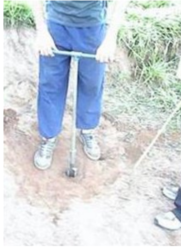
Figura 4.30 – Execução do furo utilizando o trado manual para a instalação do Guelph
