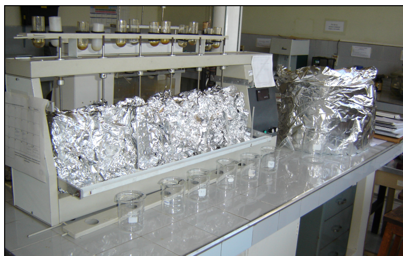
Figura 4.7: Recipientes envolvidos com papel alumínio durante os experimentos, visando a minimizar o efeito da fotodegradação do etinilestradiol.
