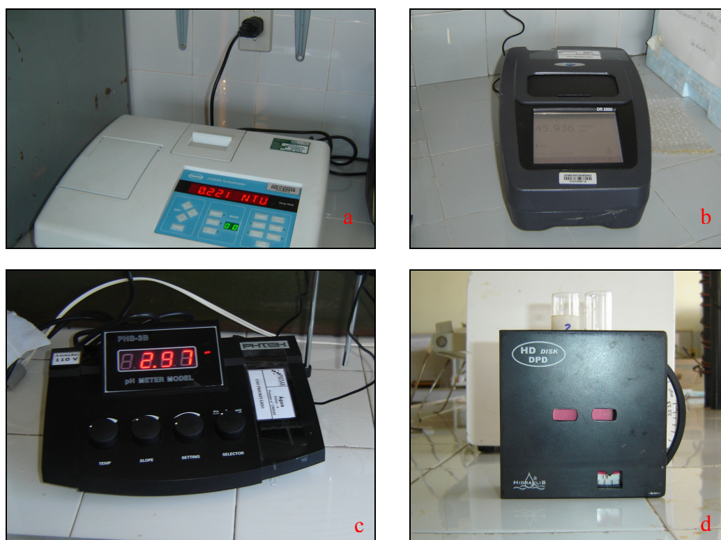
Figura 4.3: Equipamentos utilizados na caracterização da água de estudo: (a) turbidímetro; (b) espectrofotômetro; (c) potenciômetro e (d) disco colorimétrico DPD.
