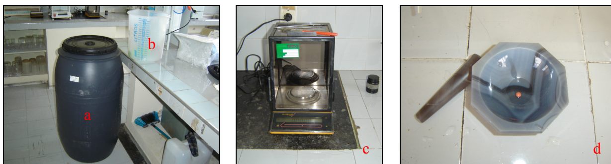
Figura 4.2: Equipamentos e materiais utilizados no preparo da água de estudo: (a) reservatório 250 L; (b) reservatório 20 L; (c) balança de precisão e (d) almofariz e pistilo de ágata.
