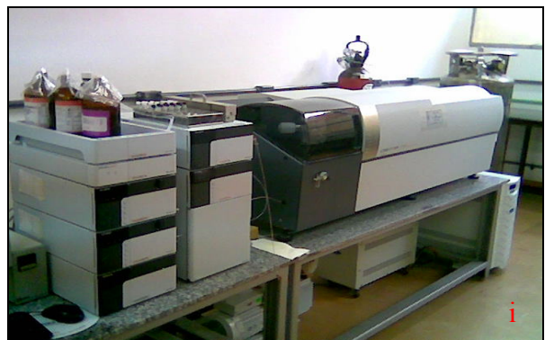
Figura 4.4: Equipamentos e materiais utilizados no preparo das amostras e na análise cromatográfica: (a) membrana de acetato de celulose; (b) kit de filtração; (c) kitassato; (d) e (g) bombas de vácuo; (e) cartuchos C18; (f) manifold ; (h) vials e (i) Cromatógrafo de fase líquida acoplado a espectrômetro de massas.
