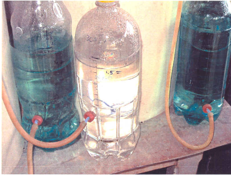
Figura 3: Foto dos gasômetros construídos em garrafas pet.
