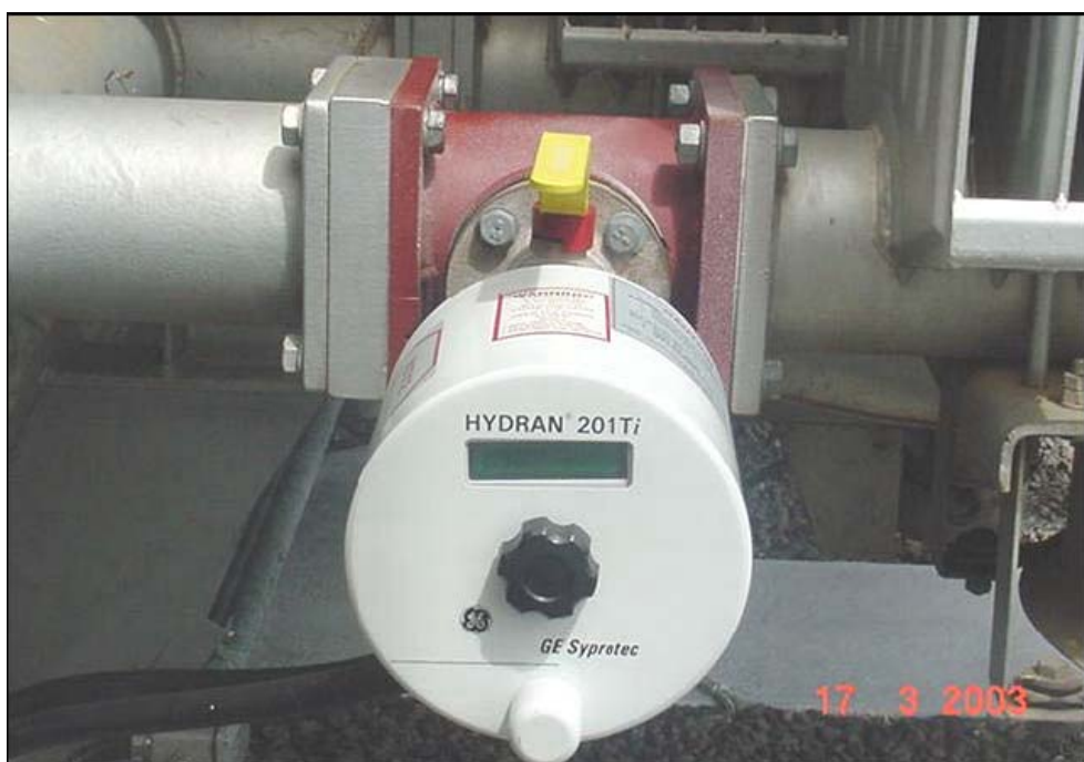
Figura 4.3 – Hydran – Sensor de Gás Dissolvido no Óleo. Fonte: [CEMIG,2006].
