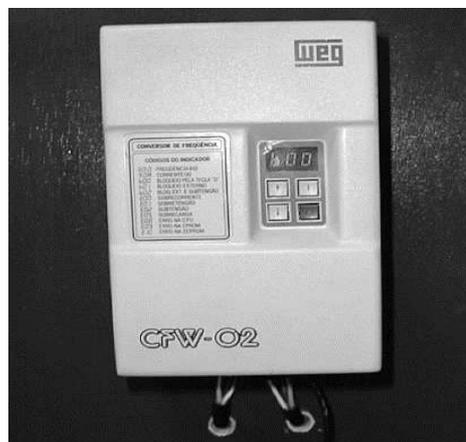
Figura 2-3 - Fotografia do conversor de freqüência.
