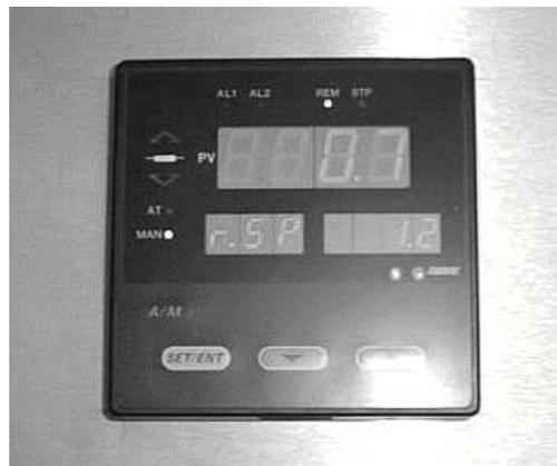
Figura 2-10 - Fotografia do controlador do tipo PID UT 37 da Yokogawa.
