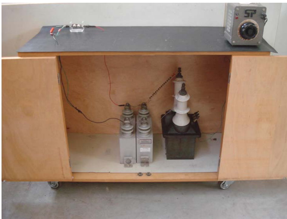
Figura 3.5 - Gerador de Impulsos móvel desenvolvido
