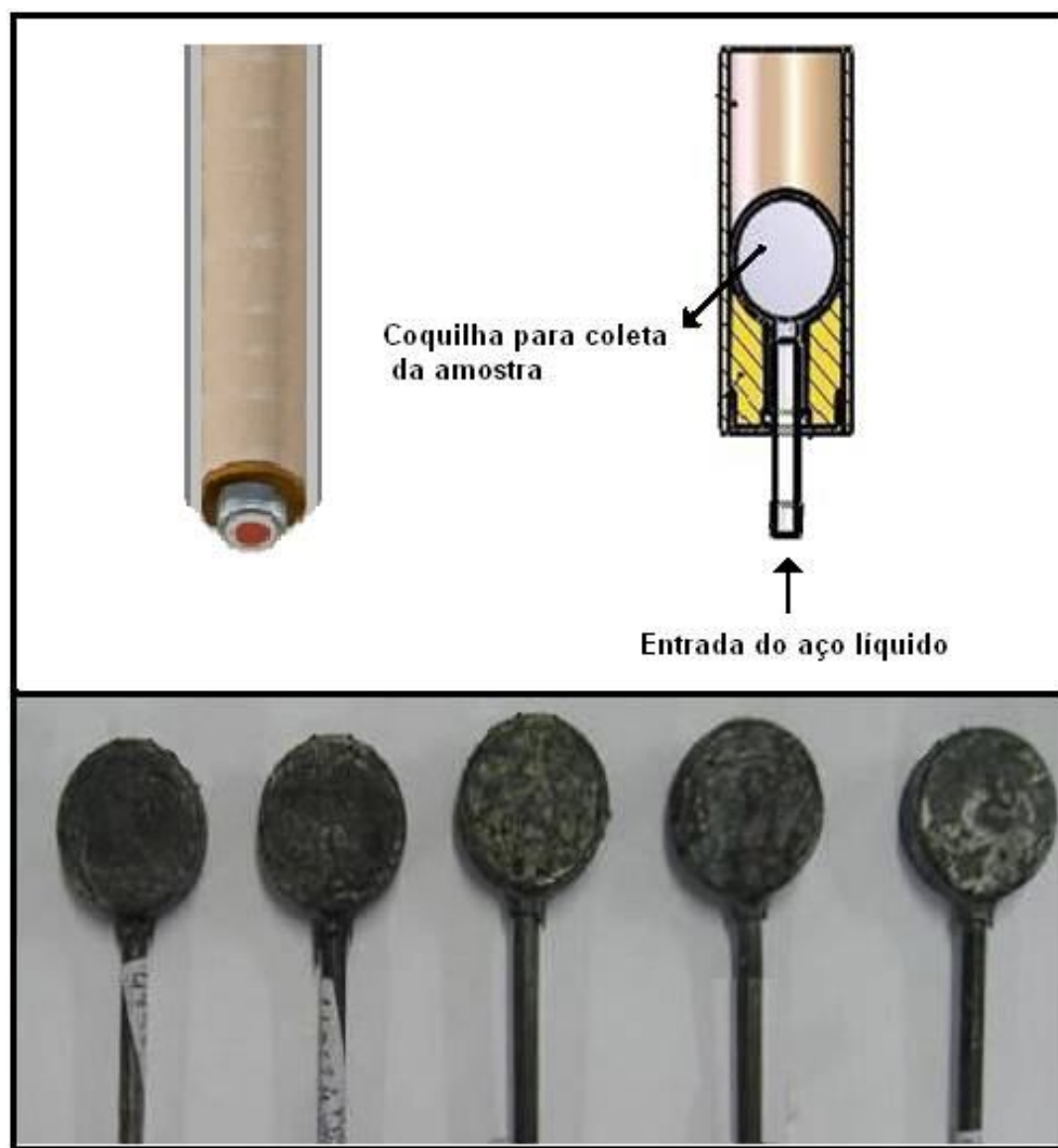
Figura 4.5 – Esquema do amostrador utilizado (acima) e as amostra de aço (abaixo).
