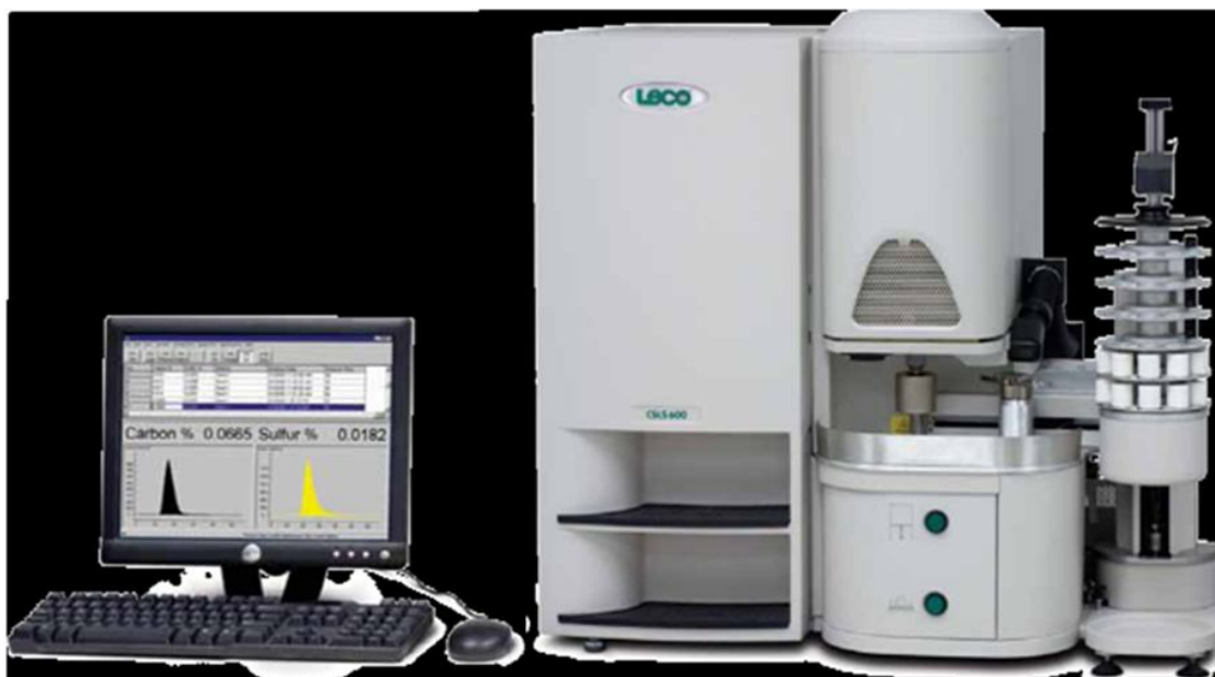
Figura 4.7 – Forno de indução com análise de carbono por infravermelho e software para leitura do teor de carbono.
