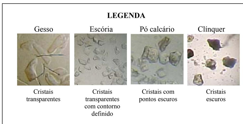
Figura 5.7 – Materiais componentes do cimento
