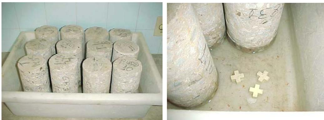
Figura 5.3 – Ensaio de absorção de água por capilaridade
