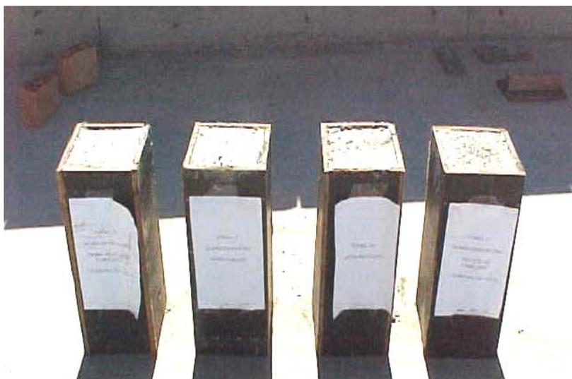
Figura 5.1 – Pilares em miniatura moldados em obra durante a concretagem
