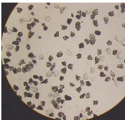
Figura 5.10 – Ampliação de imagem microscópica dos grãos do cimento CPII E 32
