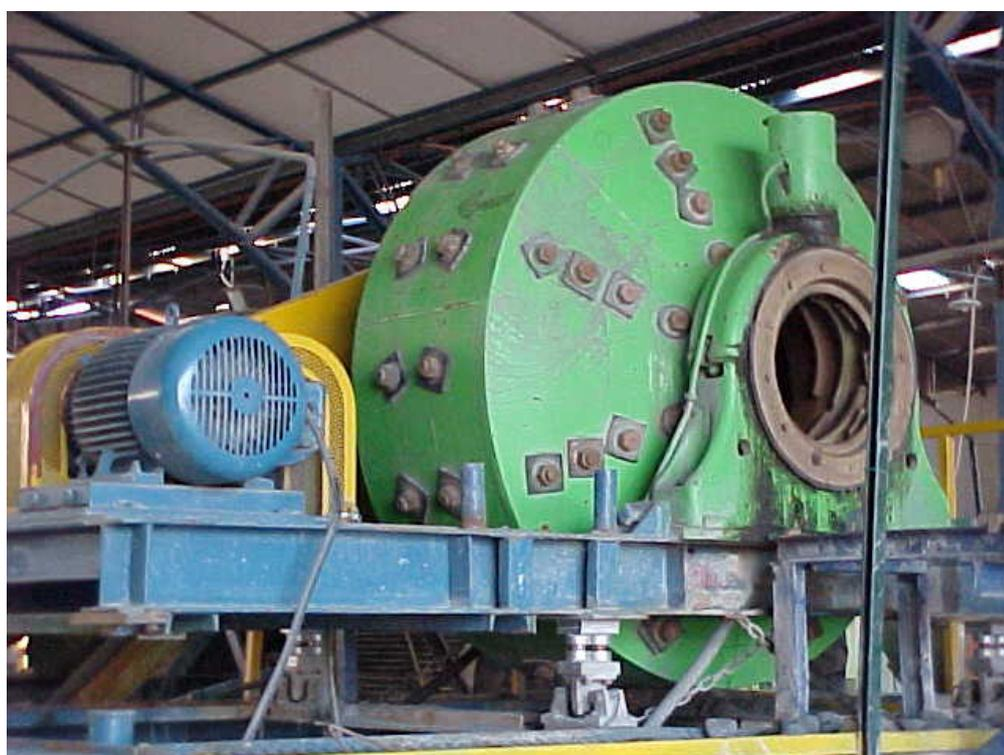
**Figura 4.4** – Moinho 6' x 2' para testes piloto (Fonte: CVRD, 2000)
