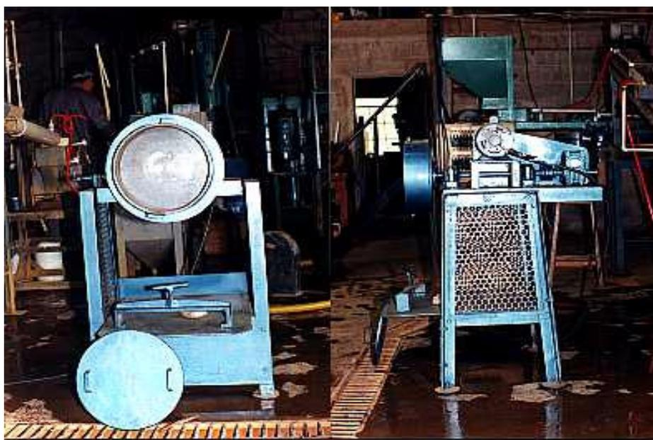
**Figura 4.7** – Vista frontal e lateral do moinho para determinação de SPI (Fonte: CVRD, 2000)
