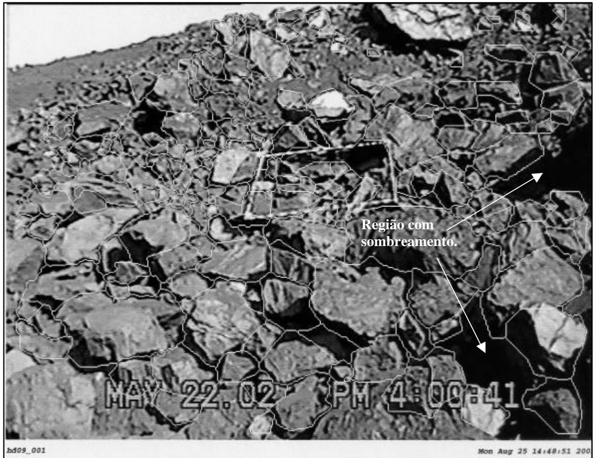
Figura 6.19: Rede de contorno com a presença de áreas sombreadas, causando a não detecção dos fragmentos de rocha.
