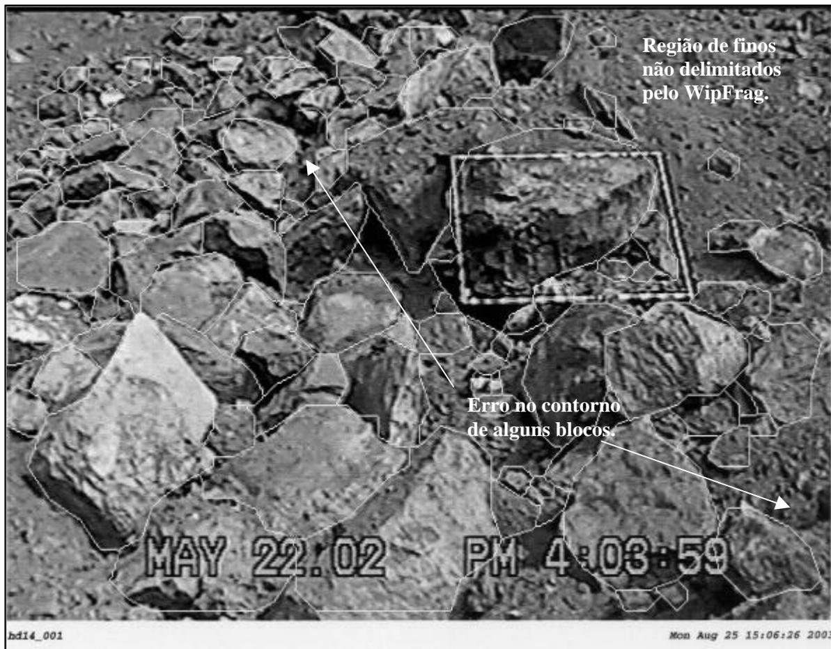
Figura 6.17: Rede de contorno com erro na delimitação de blocos e com algumas regiões de não detecção dos finos.
