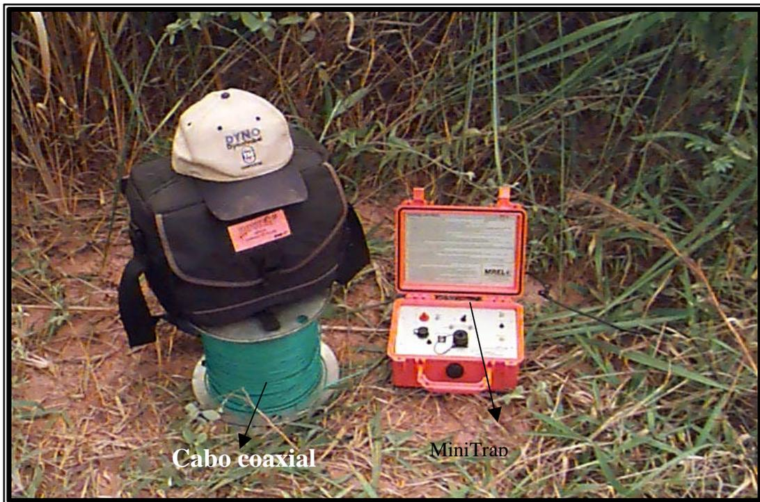
Figura 4.3: Vista detalhada do equipamento de medição de VOD MiniTrap.
