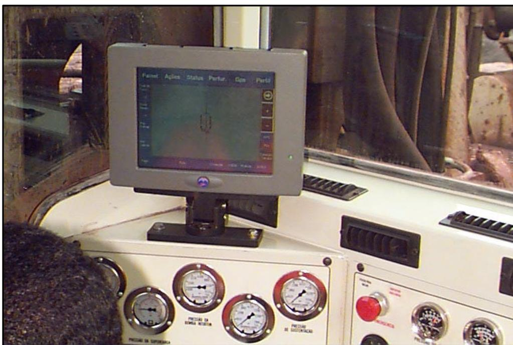
Figura 17: Painel CGC do sistema HP-DS instalado na perfuratriz DML de Carajás.
