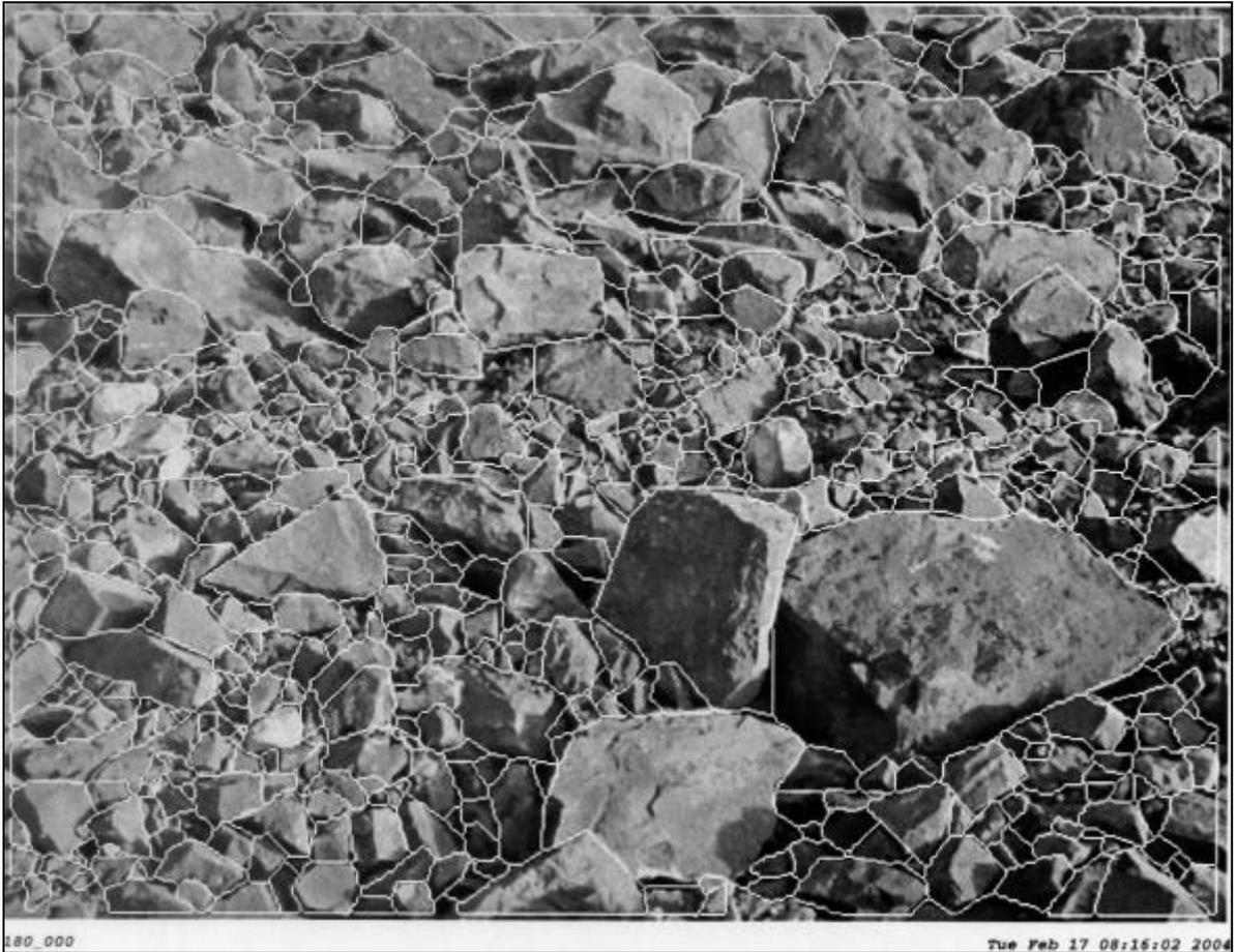
Figura 6.26: Rede de contorno gerada pelo programa WipFrag para a pilha detonada do granito da mina do Sossego.
