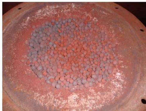
Figura 5.183 – Aspecto final das pelotas da amostra A31 após teste de queima em *Pot Grate*.
