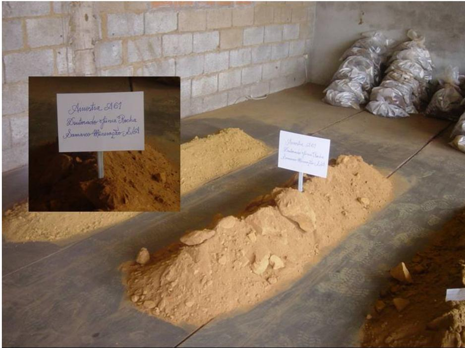
Figura 4.2 – Fotografia da amostra A61 (400kg) antes do início de sua preparação.
