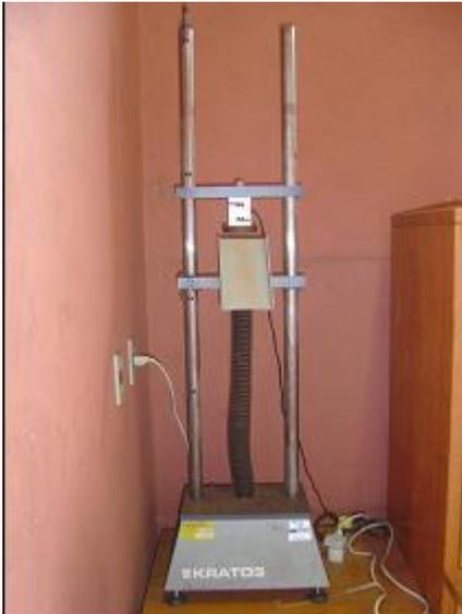
É utilizado para realizar o teste, a máquina de ensaios Kratos da DEK-MP, desenvolvida para atuar nos mais diversos campos, sendo sua característica principal fazer ensaios de tração e compressão.
