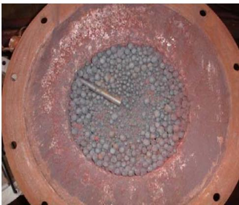
Figura 5.185 – Aspecto final das pelotas da amostra A62 após teste de queima em *Pot Grate*.
