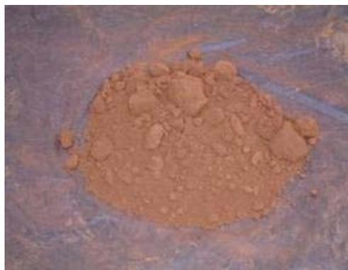
Figura 5.178 – Aspecto do concentrado da amostra A31 antes do pelotamento.
