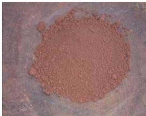
Figura 5.181 – Aspecto do concentrado da amostra A91 antes do pelotamento.
