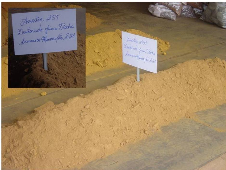
Figura 4.4 – Fotografia da amostra A91 (400kg) antes do início de sua preparação.
