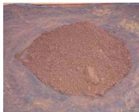
Figura 5.179 – Aspecto do concentrado da amostra A61 antes do pelotamento.
