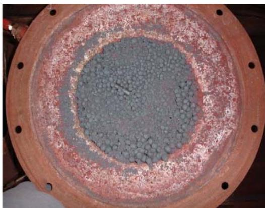
Figura 5.186 – Aspecto final das pelotas da amostra A91 após teste de queima em *Pot Grate*.
