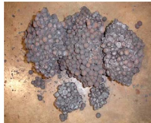
Figura 5.184 – Aspecto final das pelotas da amostra A61 após teste de queima em *Pot Grate*.
