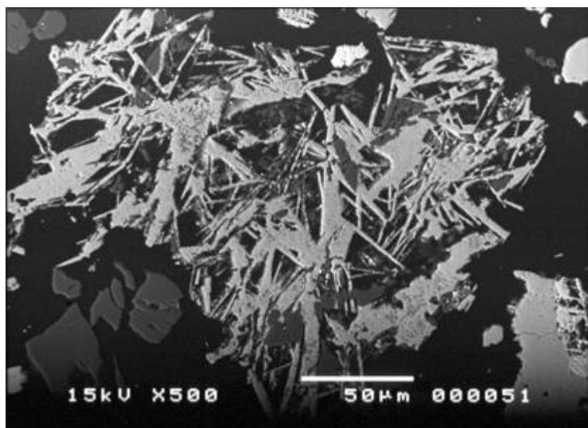
Figura 5.50 – Fotomicrografia da amostra A61 (alíquota *Underflow* Deslamado) mostrando aspecto da hematita martítica muito porosa. MEV-IRE. 500X.
