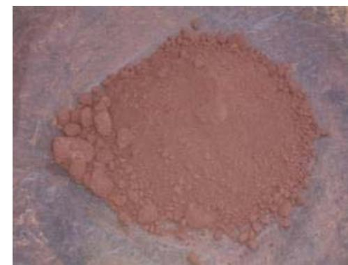
Figura 5.182 – Aspecto do concentrado da amostra A93 antes do pelotamento.
