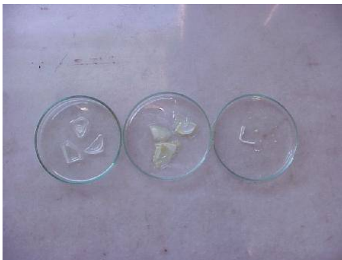
Figura VI.7- Aspecto de filmes de poliuretano puro após 24h de hidrólise em solução NaOH (3%). Da esquerda para a direita: PUD-1, PUD-5, PUD-7.
