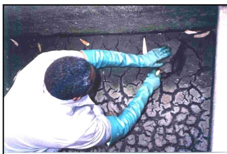
**Figura 4.6** - Coleta do lodo no leito de secagem.
