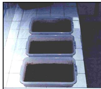
**Figura 4.9** - Procedimento de caleação do lodo    **Figura 4.10** – Mistura entre o lodo e cal
