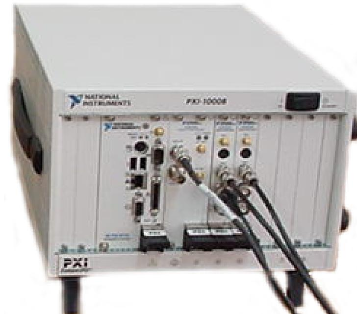
Figura 6.14: *Rack* de instrumentação.
