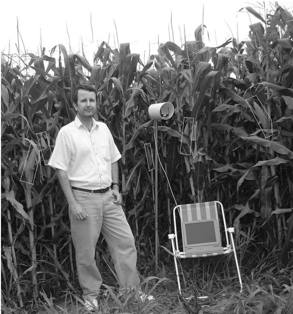
Figura 7.3 – Ponto de acesso do sistema de medição distribuída de teor de água operando na fazenda Pinheiro (Lavras/MG). Plantas no estágio R3. Altura das espigas varia de 1,1 m a 1,4 m do solo.
