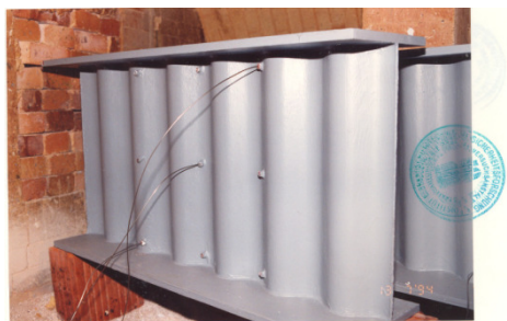
Figura 2.2: Corpos de prova e posição dos sensores (IBS, 1994)
