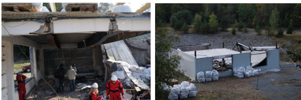
Figura 2.18: A estrutura ao fim do ensaio (Wald & Kallerová, 2009).
