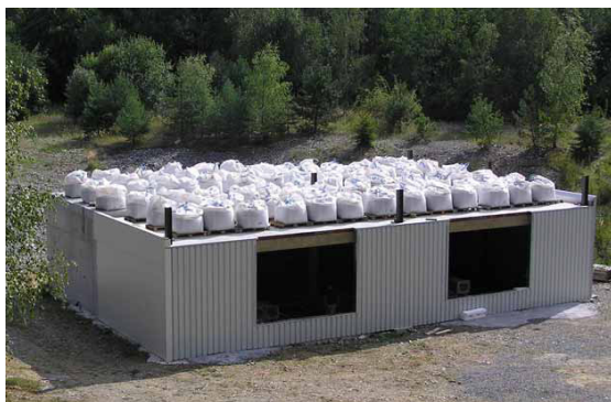
a) Posição do carregamento na estrutura
