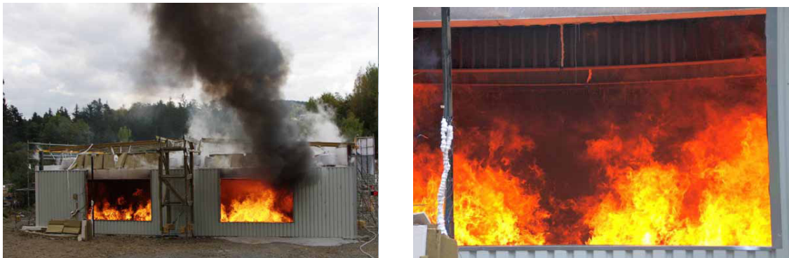
Figura 2.12: Estrutura aos 36 min de ensaio, vigas de alma senoidal aos 47 min de ensaio (Wald & Kallerová, 2009).
