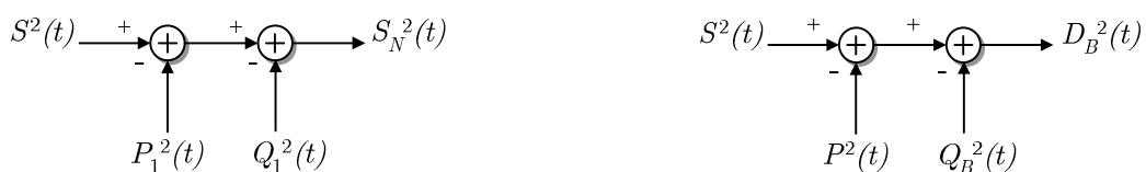
Fig. 7.16 – Cálculo da potência aparente de distorção S_N (à esq.) e da potência de distorção de Budeanu D_B .
