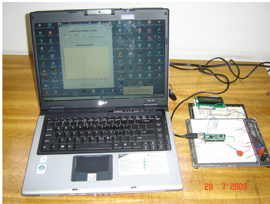
Figura 4.2: Sistema implementado para auto-calibração e linearização dos sensores
