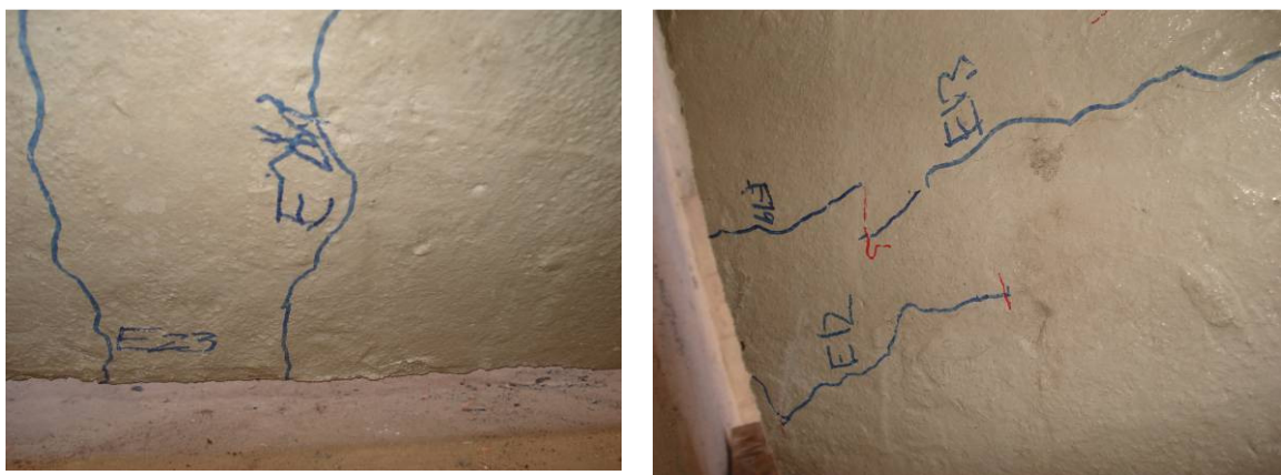
FIGURA 4.48 – Fissuração face inferior do modelo 2BE.
