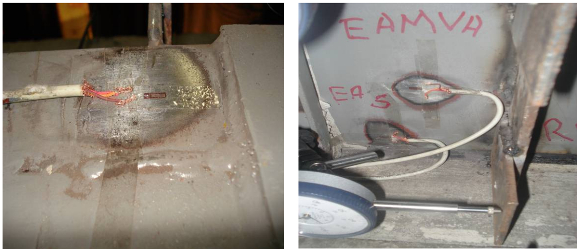
FIGURA 3.24 – Extensômetros na mesa e na alma da viga.
