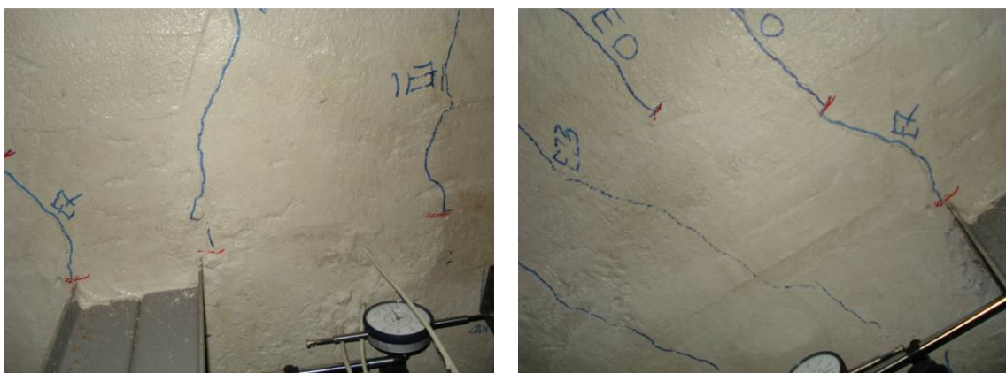
FIGURA 4.45 - Fissuração da face superior do modelo 1BE.
