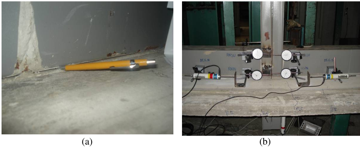
FIGURA 4.20– a) Efeito Up-lift no modelo 1BE b) Transdutores de deslocamentos para medição dos deslizamentos entre o concreto e o aço.
