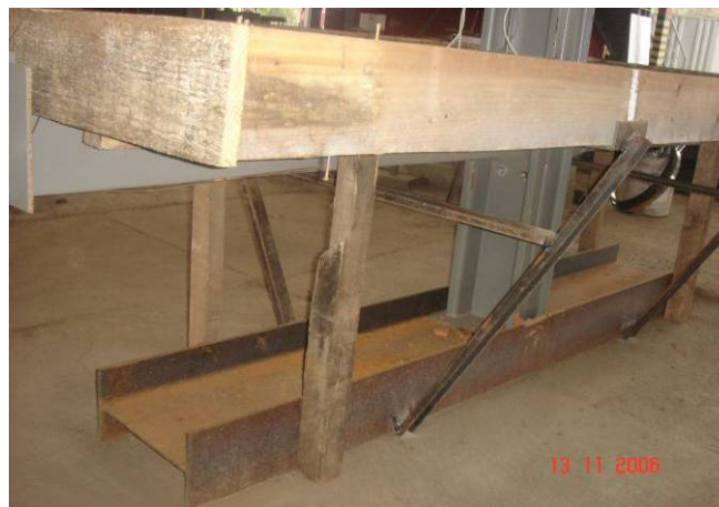
FIGURA 3.10– Esquema da ancoragem do modelo.
