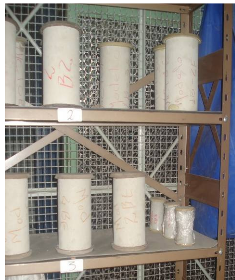
FIGURA 3.31 – Corpos de prova ensaiados para determinação do f_{ck} .
