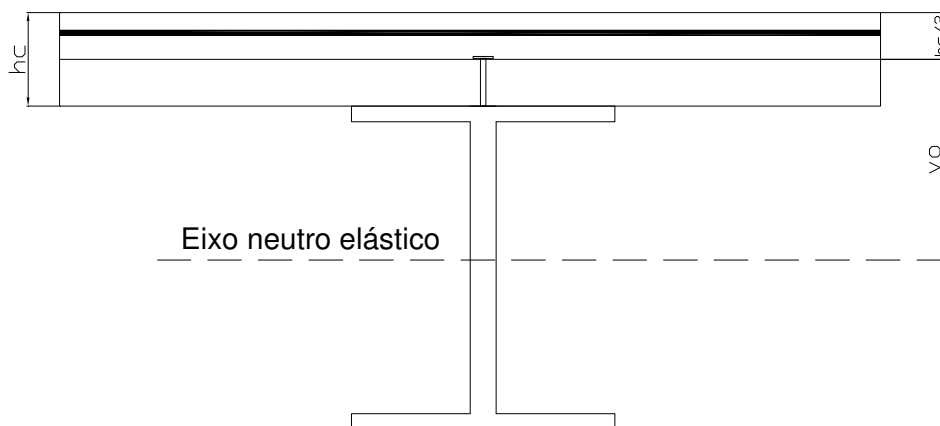
FIGURA 2.12 – Definição dos termos para o cálculo do coeficiente \alpha_c
