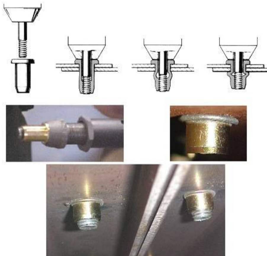
FIGURA 3.4 – Etapas de instalação da porca-rebite.
