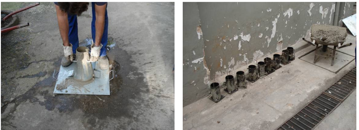
FIGURA 3.16 – Medição slump do concreto no LAEES.
