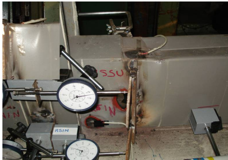
FIGURA 4.17 – Flambagem local da mesa comprimida do modelo 2BE.
