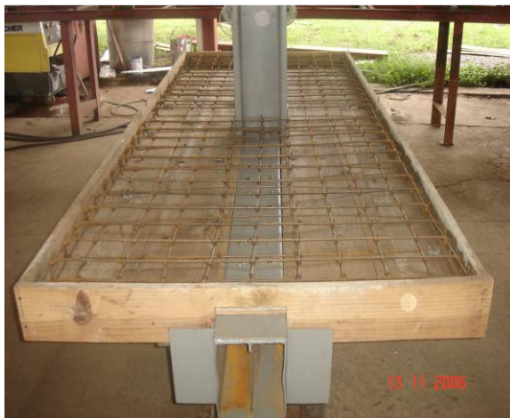
FIGURA 3.13 – Detalhe das armaduras e instrumentação das barras de aço.
