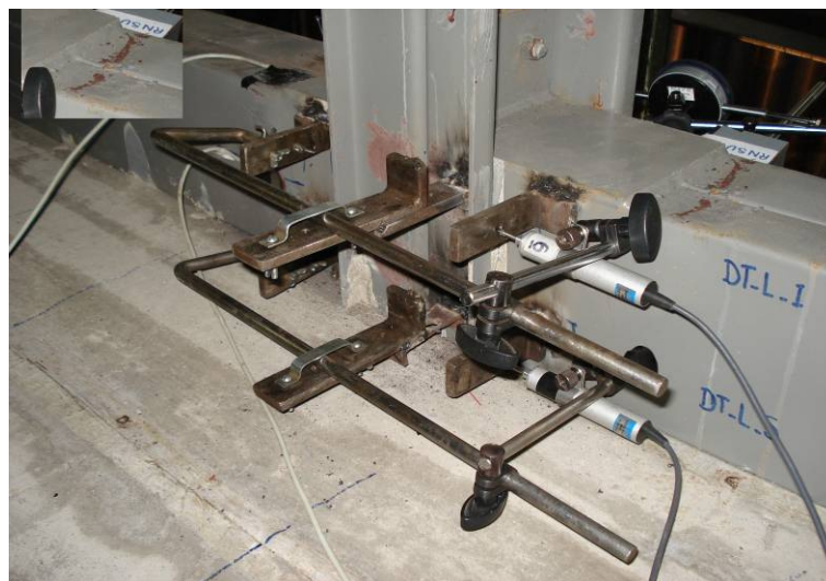
FIGURA 4.9 – Flambagem local da mesa comprimida do modelo 2A.
