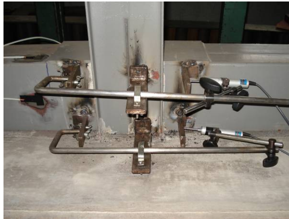
FIGURA 3.21 – Transdutores de deslocamentos da ligação.
