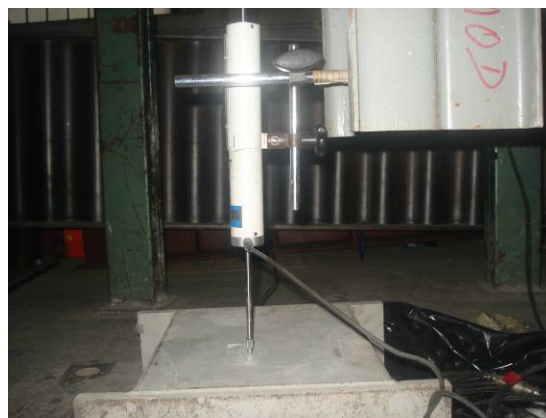
FIGURA 3.20 – Posicionamento do transdutor de deslocamento vertical na seção central do modelo.
