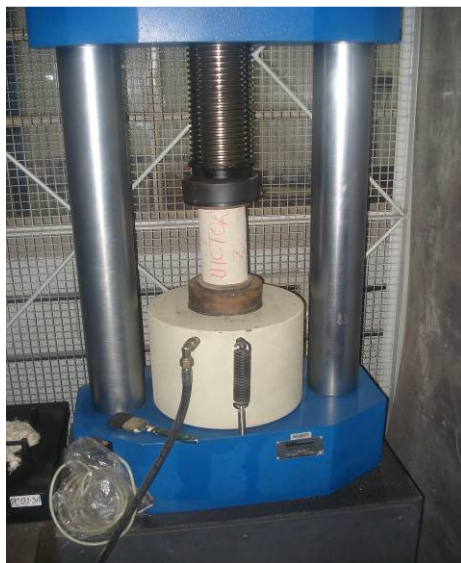
FIGURA 3.31 – Corpos de prova ensaiados para determinação do f_{ck} .
