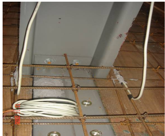
FIGURA 3.13 – Detalhe das armaduras e instrumentação das barras de aço.
