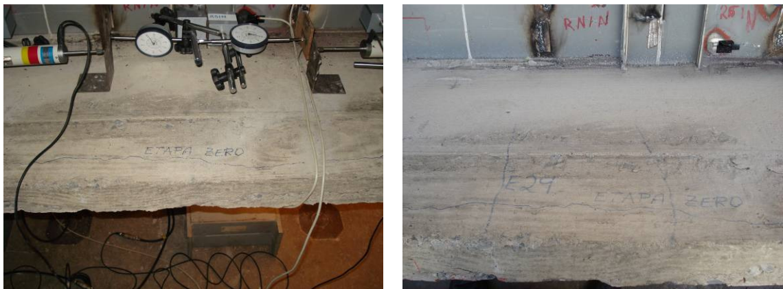
FIGURA 4.48 – Fissuração face inferior do modelo 2BE.
