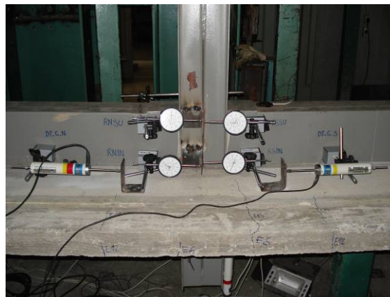
FIGURA 3.22 – Relógios comparadores para medir a rotação relativa da ligação.
