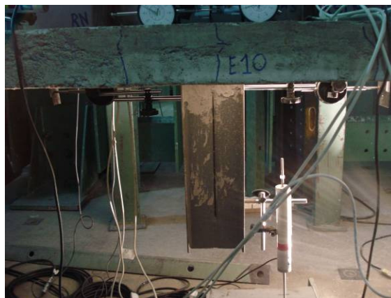
FIGURA 4.52 – DT-100mm para medição do deslocamento vertical.
