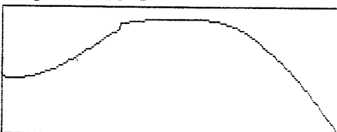
Figura 33 - Resultados gráficos do programa RESP0D para o arquivo de dados RENGEP.DAT (laje engastada com deslocamento máximo na faixa elastoplástica )
