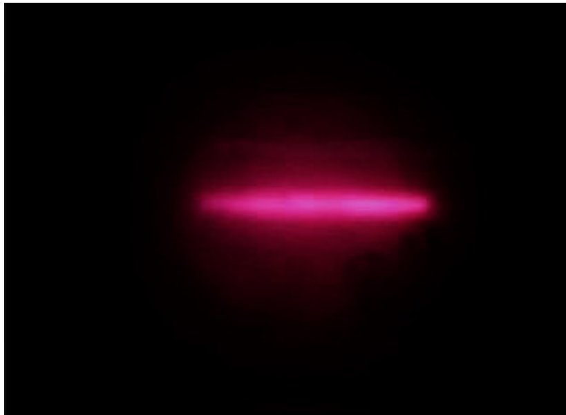
Figura 7.10: Fotografia do arco elétrico apresentando ressonância acústica.
