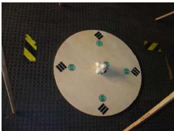
Figura 15: Disco utilizado para suporte do medidor isotrópico.
