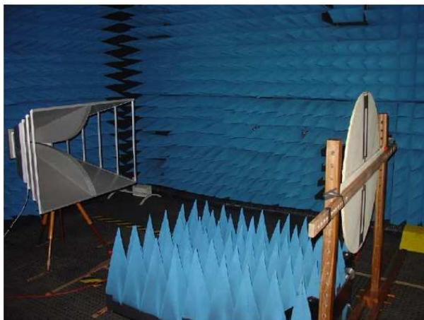
Figura 20: Montagem utilizada para Experimento 1.2, com absorvedores no solo.
