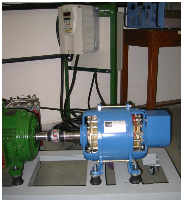
Figura 4.13 – Bancada de ensaios do motor Frank no LAI / UFMG.
