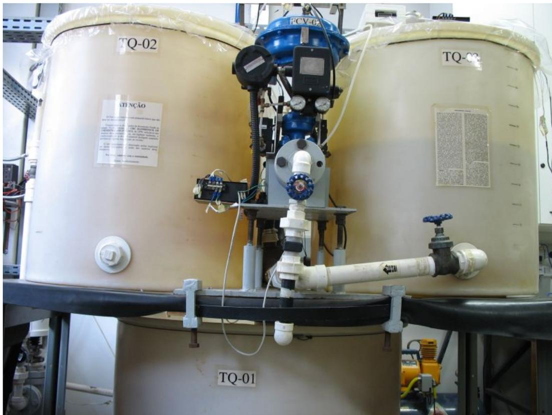
Figura 2.4: Foto do sistema de tanques interativos
