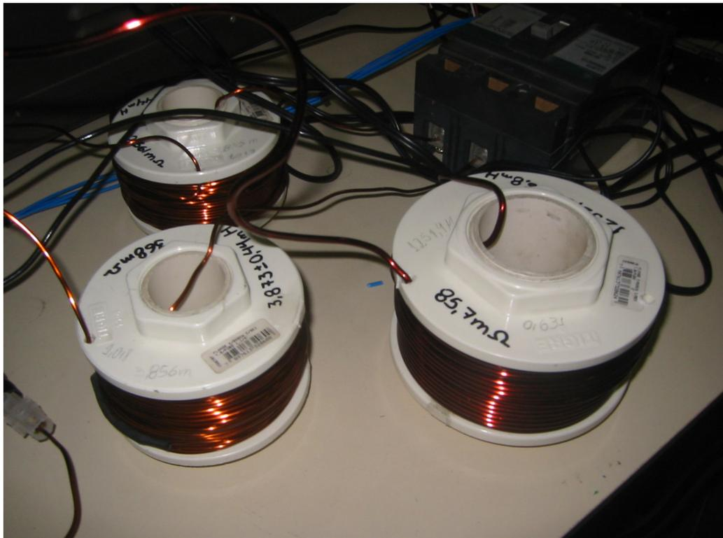
Figura A1.4 Aspecto final dos elementos reativos construídos para o filtro senoidal.
