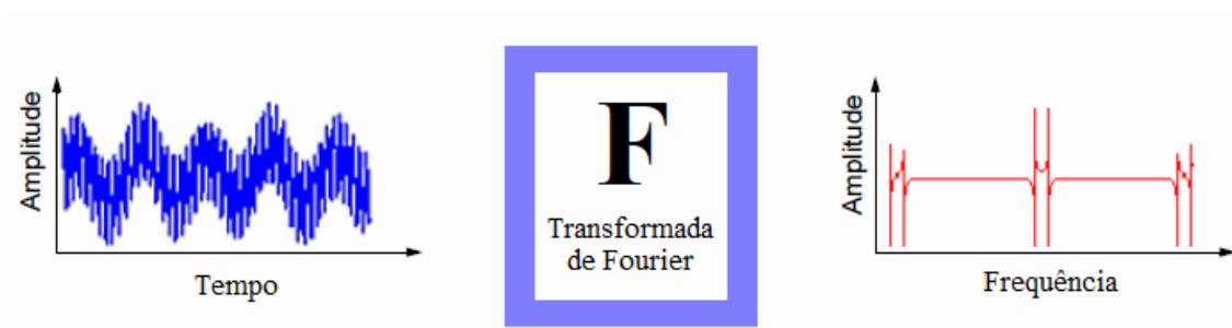
Figura 3. 1: Aplicação da Transformada de Fourier.
