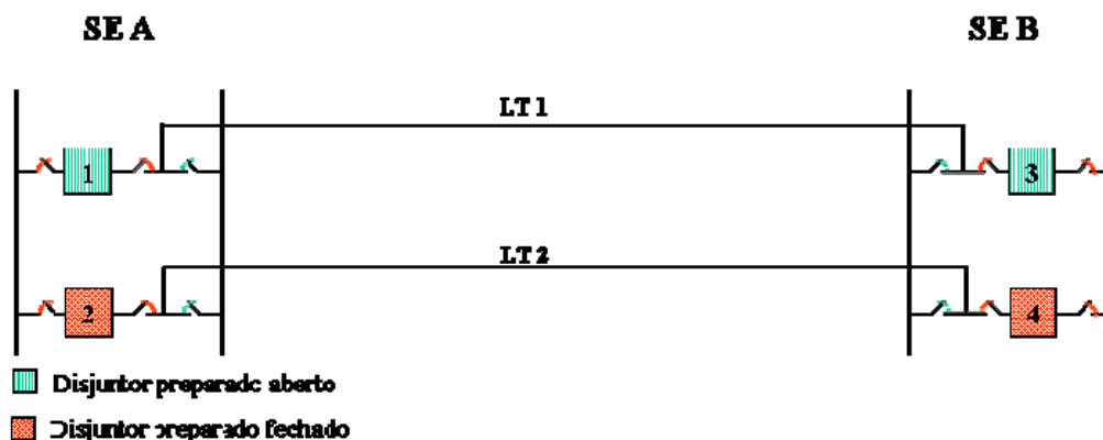
Figura 5.5 – Preparação Alternativa pela Linha de Transmissão 2.
