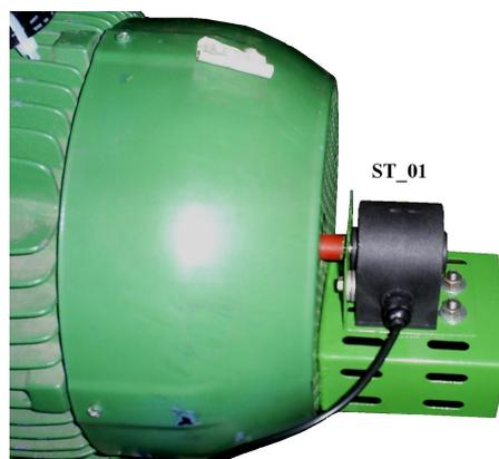
Figura 2.9: Encoder utilizado para medição da velocidade angular do eixo do motor.
