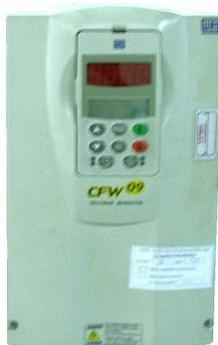
Figura 2.4: Inversor de frequência.
