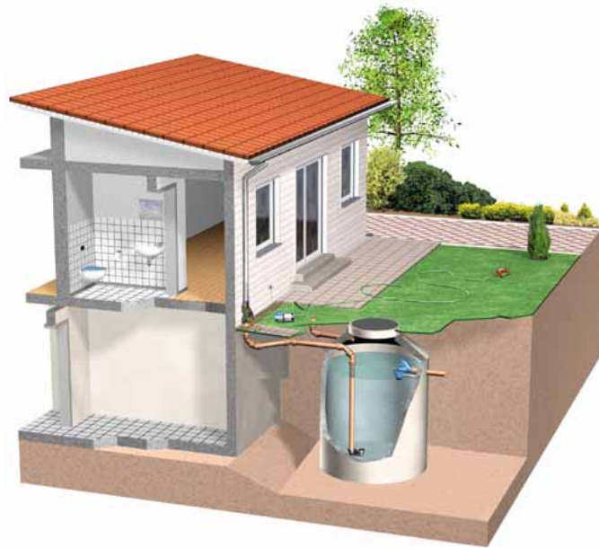
Figura 3-5 – Sistema de Aproveitamento da Água Pluvial
