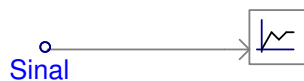
Figura A.11: Estrutura para estabelecer a conexão entre os sinais medidos e o quadro de visualização de resultados.
