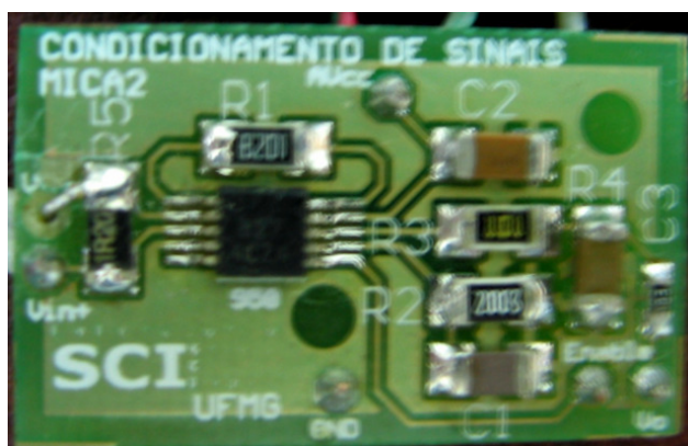
Figura 4-7: Placa de Condicionamento de Sinais do MICA2.
