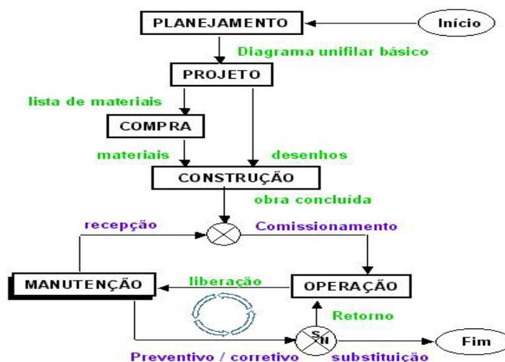
Figura 3.4 - Processos envolvidos no ciclo de vida dos equipamentos
