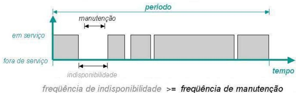
Figura 3.14 - Frequência de Manutenção
