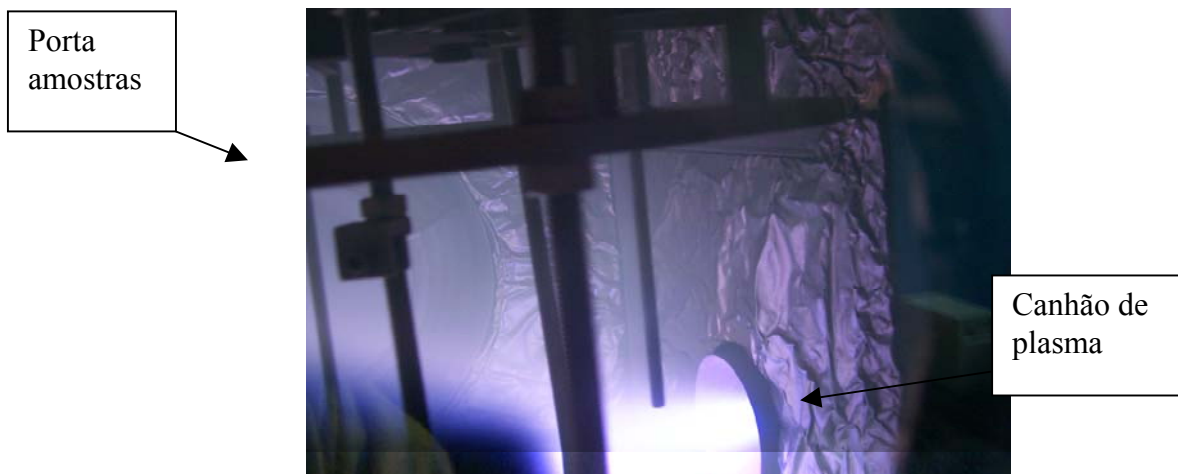
FIG. 3.11 – Canhão de plasma de Argônio na câmara BAI 640R durante deposição
