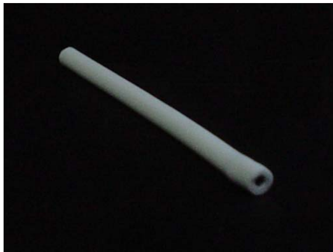
Figura 4.13: Tubo isolante de silicone utilizado para revestir a associação de resistores.
