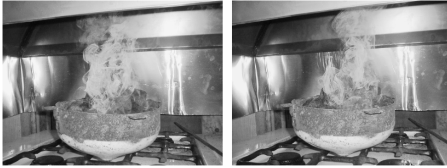
Figura 5.16: Suspensão de fumaça, devida à queima de café, para testes de filtração eletrostática.
