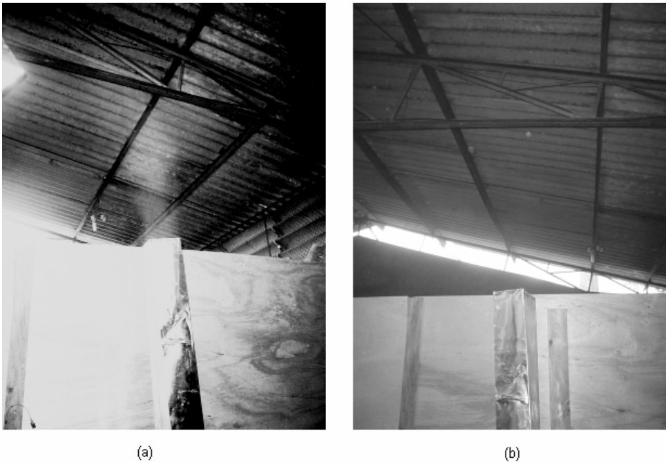
Figura 5.17: Verificação visual do processo de filtração eletrostática de fumaça de queima de café. (a) Conversor de alta tensão desligado. (b) Conversor ligado.
