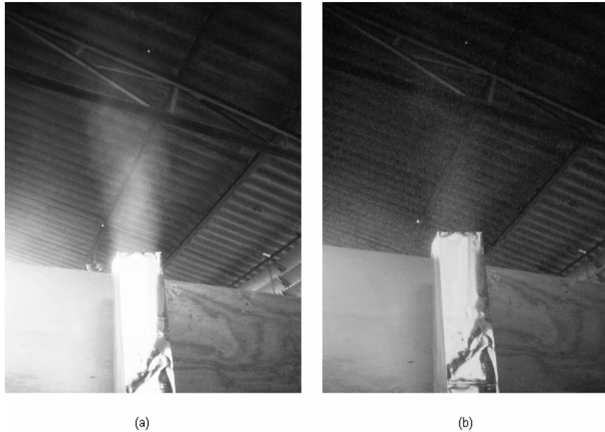
Figura 5.15: Verificação visual do processo de filtragem eletrostática de partículas de gordura. (a) Conversor de alta tensão desligado. (b) Conversor ligado.
