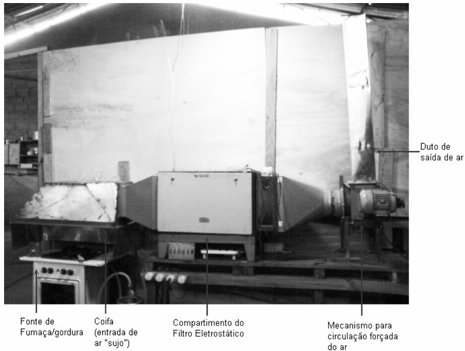
Figura 5.1: Montagem realizada para os testes de filtração eletrostática.
