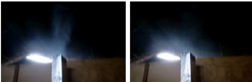
Figura 5.18: Verificação visual do processo de filtragem eletrostática de fumaça de queima de tecido sintético. (a) Conversor original. (b) Novos conversores.
