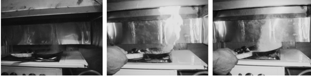
Figura 5.14: Suspensão de partículas de gordura para testes de filtração eletrostática.
