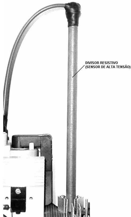
Figura 4.15: Fixação do divisor resistivo no circuito impresso do conversor.
