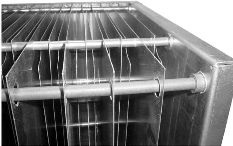
Figura 3.10: O suporte do ionizador afixado em suas extremidades.
