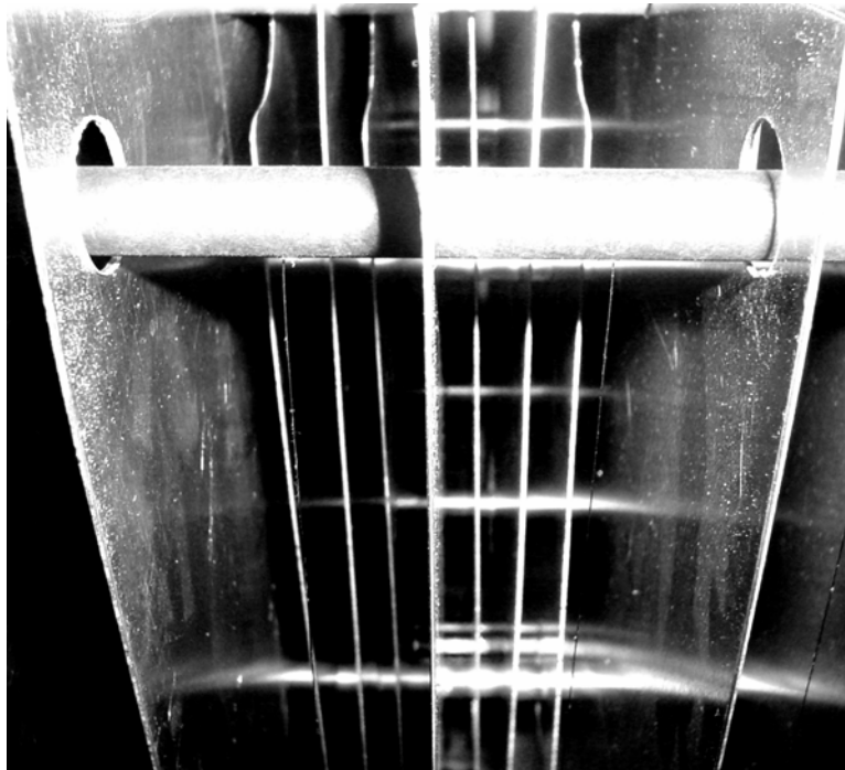
Figura 3.11: Fio ionizador preso ao suporte isolado, no ponto central entre cada conjunto de duas placas paralelas.
