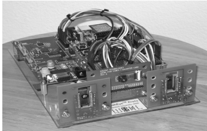
Figura 3.3: Plataforma de sensoriamento visual MeshEye desenvolvida pelo WSNL da Universidade de Stanford.
