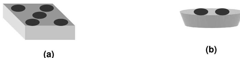
Figura 4.6 – Desenho esquemático da localização das queimas nas amostras (a) e padrão (b)
