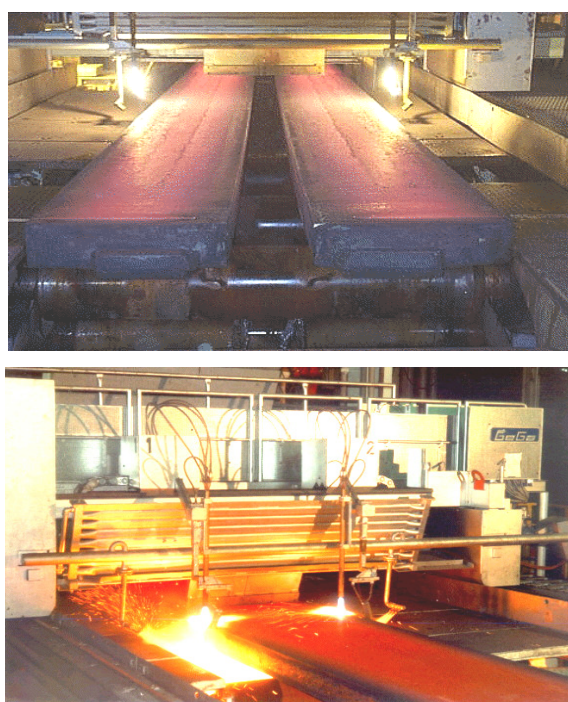
Figura3.4- Corte de Placas
