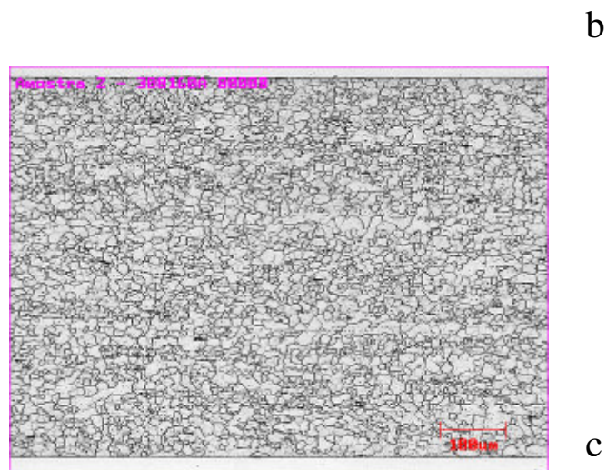
FIGURA 6.4 – Estrutura metalográfica do inoxidável ferrítico estabilizado ao níbio produzido via recozimento intermediário com ataque Vilela.
