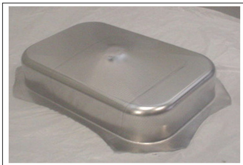
FIGURA 6.35- Cuba de 110 mm de profundidade
