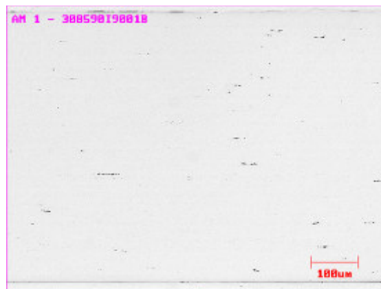
FIGURA 6.1 – Micropureza do inoxidável ferrítico estabilizado ao níbio produzido via redução direta.
