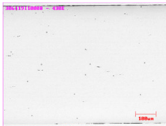
FIGURA 6.1 – Micropureza do inoxidável ferrítico estabilizado ao níbio produzido via redução direta.
