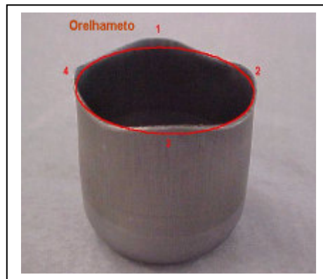
FIGURA 6.26 – Determinação das alturas de pico e vale para o cálculo do grau de orelhamento dos copos Swift
