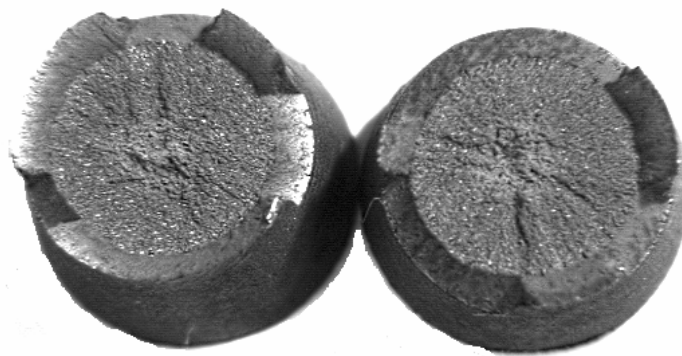
Figura 5.25 – Superfícies de fratura de amostra de fio-máquina de 14,30mm de diâmetro estocada por 40 dias a 25°C e testada na temperatura ambiente. 20X.
