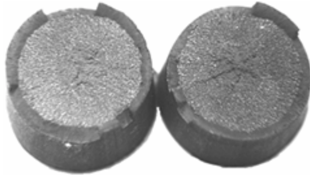
Figura 5.24 – Superfícies de fratura de amostra de fio-máquina de 14,30mm de diâmetro testada imediatamente após resfriamento no Stelmor ® na temperatura ambiente. 20X.
