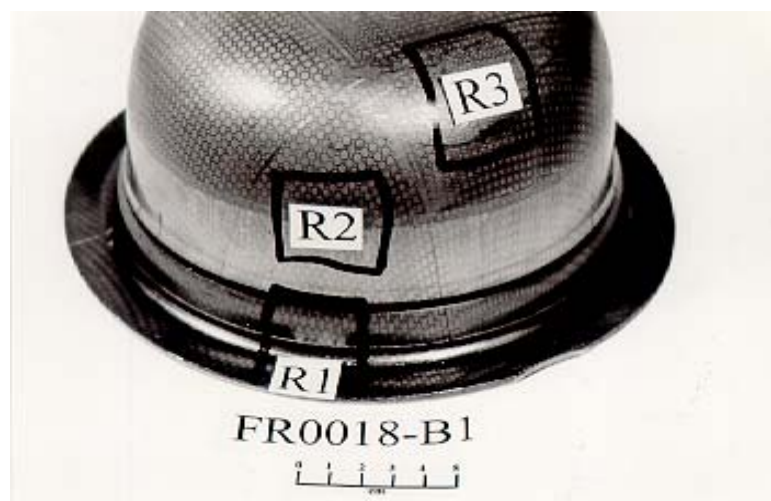
FIGURA 5.3 - Localização das regiões na carcaça do compressor onde se determinaram as deformações principais
