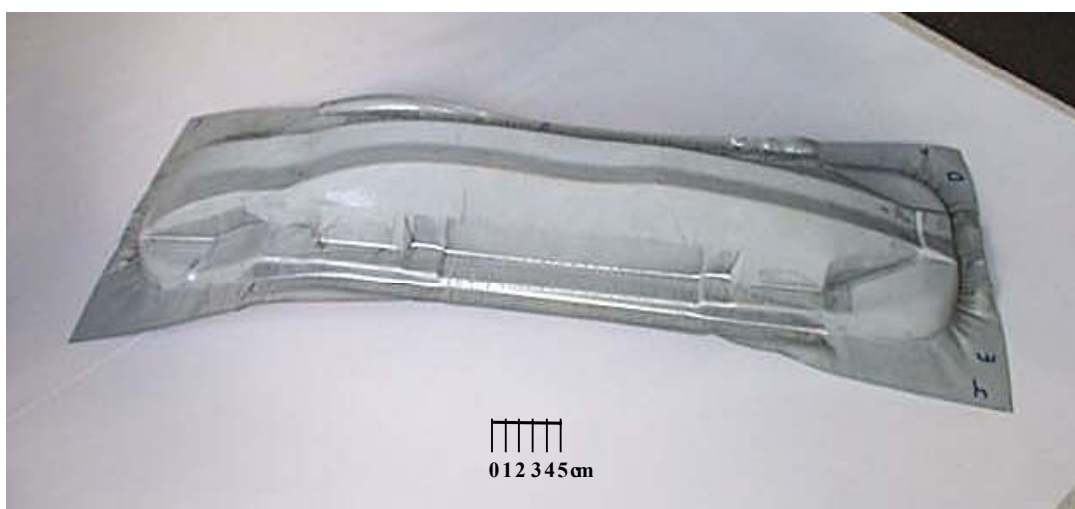
FIGURA 4.2 - Repuxo do reforço lateral da porta de um veículo leve.
