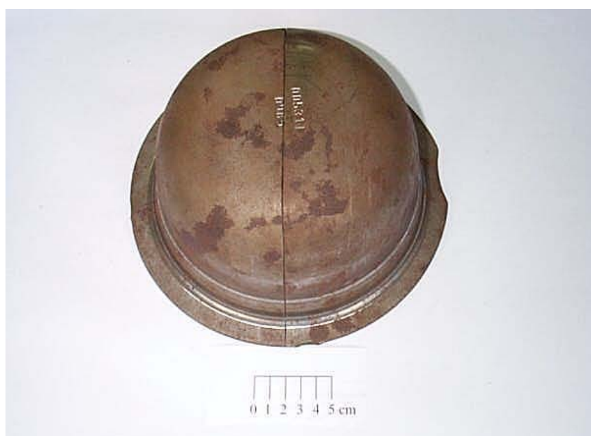
FIGURA 4.1 - Repuxo da carcaça de um compressor
