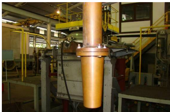
Figura 4.2 – Parte inferior da lança de amostra que entra em contato com o aço líquido.
