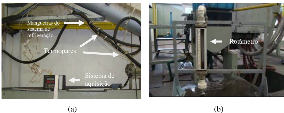
Figura 4.5 – Instrumentos de medida utilizados no teste de solidificação. (a) termopares e (b) rotâmetro.
