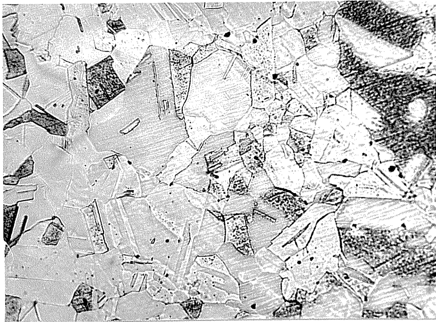
Figura 4.5 - Cobre Eletrolítico resfriado lentamente no forno após recozimento à 550°C. Corte transversal, barra D. Ataque ( H_2O -200ml, H_2SO_4 -16ml, K_2Cr_2O_7 -4g, NaCl-0,75g, durante 20 segundos) x 100.
