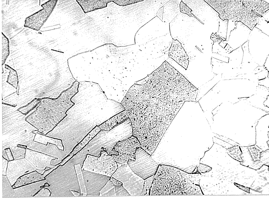
Figura 4.4 - Cobre Eletrolítico resfriado lentamente no forno após recozimento a 550°C. Corte transversal, barra C, ataque ( H_2O -200ml, H_2SO_4 -16ml, K_2Cr_2O_7 -4g, NaCl-0,75g, durante 20 segundos) x 200.
