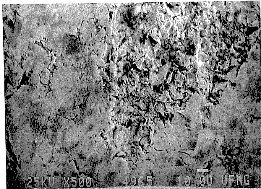
Figura 4.13 - Detalhes de alguns "poros" superficiais após a trefilação. MEV x 500.
