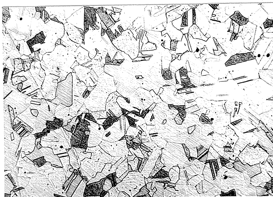
Figura 4.7 - Cobre Eletrolítico resfriado lentamente no forno após recozimento à 550°C. Corte transversal, barra F. Ataque ( H_2O -200ml, H_2SO_4 -16ml, K_2Cr_2O_7 -4g, NaCl-0,75g, durante 20 segundos) x 100.
