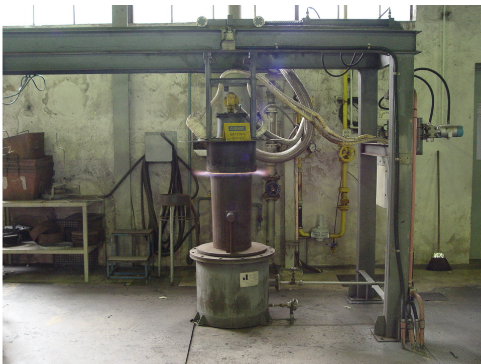
Figura 4.7 – Máquina de Sínter durante a queima
