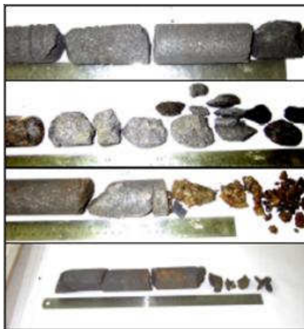
A Figura 3.16: O resultado da sondagem do cadinho do alto-forno L da ISG segundo Talaat et al (2005).
