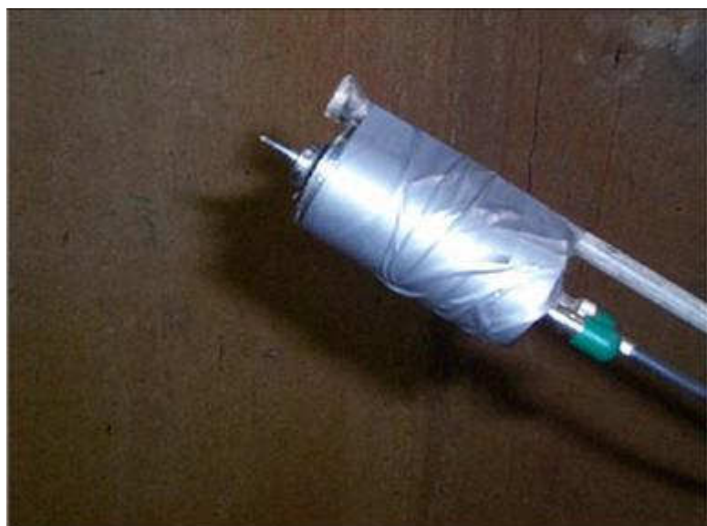
Figura 3.12: Sensor utilizado pela Hatch para fazer medição acústica segundo Sadri (2003).
