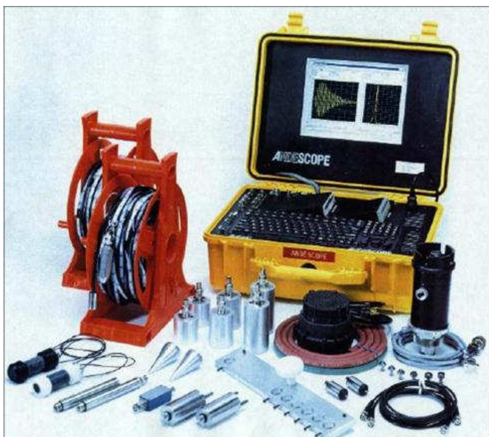
Figura 3.11: Equipamento utilizado pela Hatch para fazer medição acústica segundo Sadri (2003).
