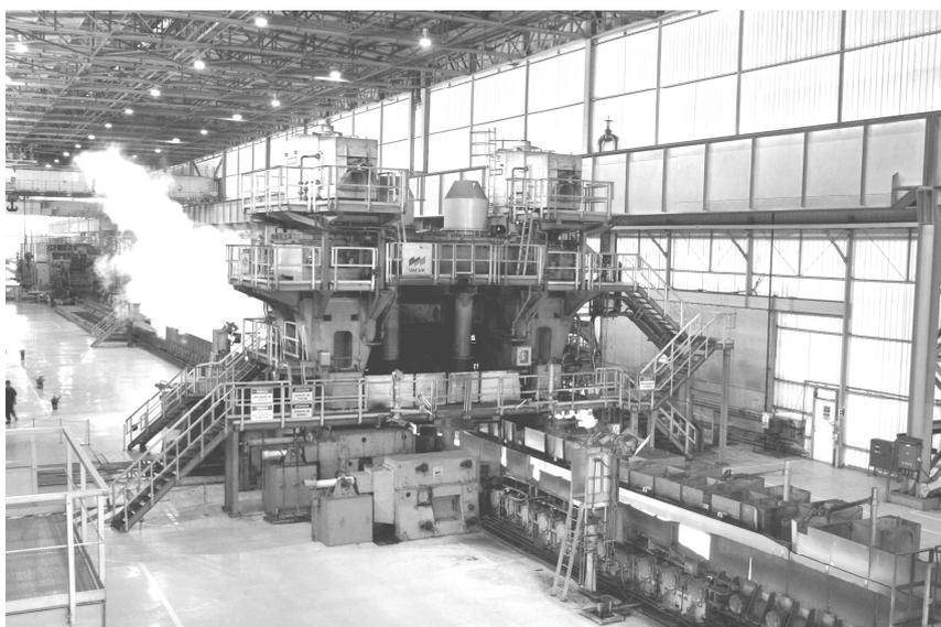
Figura 3.28 – Laminador de desbaste de esboço do laminador de tiras a quente da CST.
