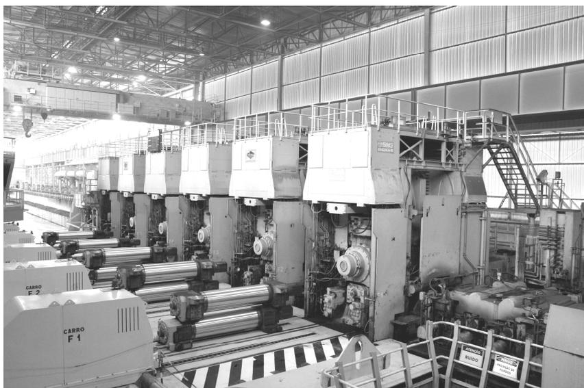
Figura 3.30 – Laminador de acabamento do laminador de tiras a quente da CST.
